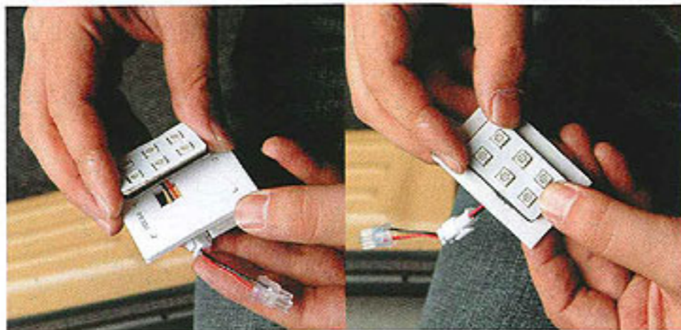
純正のルームランプ内へ確実に固定するための、専用アタッチメントが付属。LEDユニットがルームランプ内の中央へしっかりくる設計になっている。
