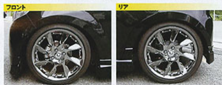
リア同様にフロントもタイヤ被りまではいかなかったが、全長調整式のためもう少し調整は効きそう。ちなみにアーチ高は約54cmだった。
