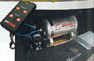
足まわりには車高調とエアサスの機能を併せ持つタナへのエアコブラを装着。小型のリモコンで8段階操作することも可能だ。
