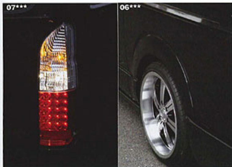
07 片割1センチまでという保安基準を意識したフェンダートリム。フラットなハイエースのサイドに、立体感を与えるアクセントとしても最適。06 ブレーキ&スモールランプにLEDバルブを使用。バックランプやウィンカーには、マルチフレクターを使う澄びやかなLEDテール。
