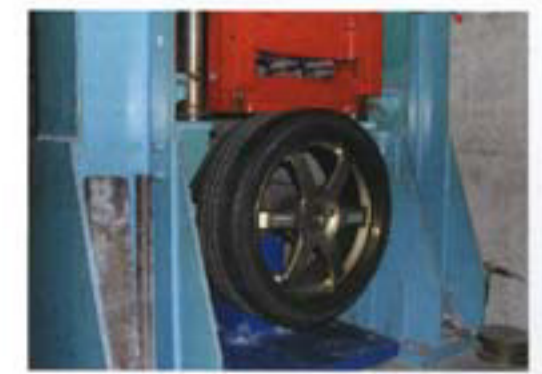
社内テストの風景。衝撃を与える、捻る、タイヤを削らせて50万回転させるなど、その内容は多岐に渡る。
