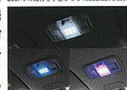
純正バルブと交換可能なLEDバルブは1つのバルブで白・青・ピンクの3色切り替え可能。
