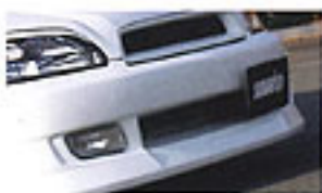
当初、完成したフロントバンパーがイライラにもボリュームが足りなかったため、バンパー部の厚みをさらに30mmアップした。メッシュのグリルは純正加工タイプ
