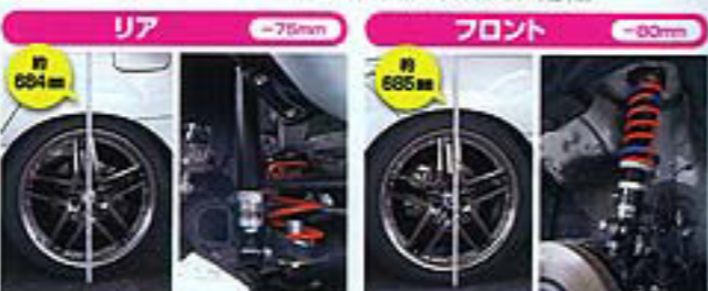
フロントは純正と異なりマイナスイヤのダウンを付けている。フロントも60インチライムを装着した状態では、純正のフロントサスペンションのバネの長さよりも約68mm短くなっている。この状態で、タイヤのローダウンが実現している。また、純正のタイヤの幅も60mm短くなっている。
