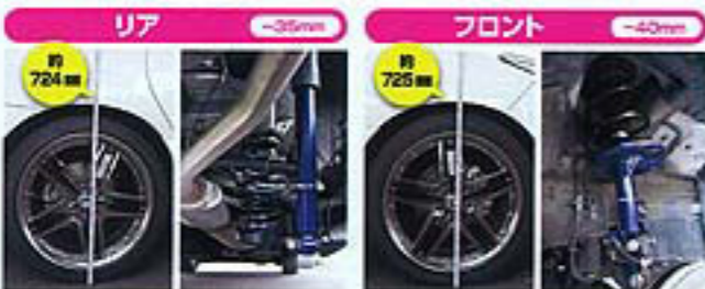
リアは純正と異なりマイナスイヤのダウンを付けている。これも60インチライムを装着した状態では、純正のリアサスペンションのバネの長さよりも約75mm短くなっている。タイヤのローダウンが実現しているから、実用性がかなり高まっている。また、純正のタイヤの幅も60mm短くなっている。
