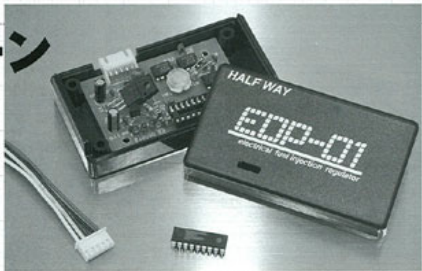
タント専用の最適なデータがインプットされた本体ユニットは、コストを抑えるために置いてシンプル。装着はわずか5本の配線をECUに接続するだけだ。
