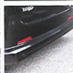
純正バンパーのボトムに取り付けられたハーフスポイラー。ボトムを迫り出すようにデザインすることで、フェイスにメリハリを加える。
