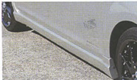
▲内容きフォルムで引き締まったラインを作るサイドステップ。取り付けに関してはセンターのビス打ちがなく、両面テープと前後インナーフェンダー部分だけで固定できる
