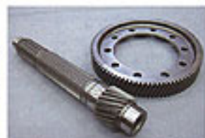
ファイナルギアはノーマルの4.1から4.6にローギアード化することで、シフトのつながりがアップするほか、加速性能も向上。モータアシストへの悪影響も少ないという。
